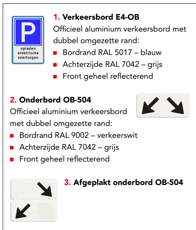
Figuur 2. Overzicht van verkeersborden en onderborden die geplaatst dienen te worden op een laadlocatie
