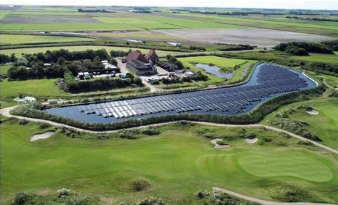
Voorbeeld voor drijvende zonnepanelen. Tijdelijke toepassing in het oostelijk deel van Buiteneiland, tijdens de aanleg.
