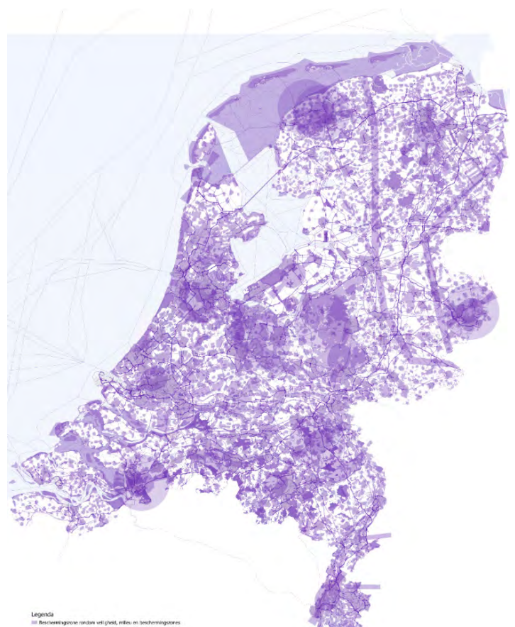
BEPERKINGEN VOOR PLAATSING VAN EEN WINDTURBINE (2,3MW) IN- EN EXCLUSIEF HET NATUUR NETWERK
