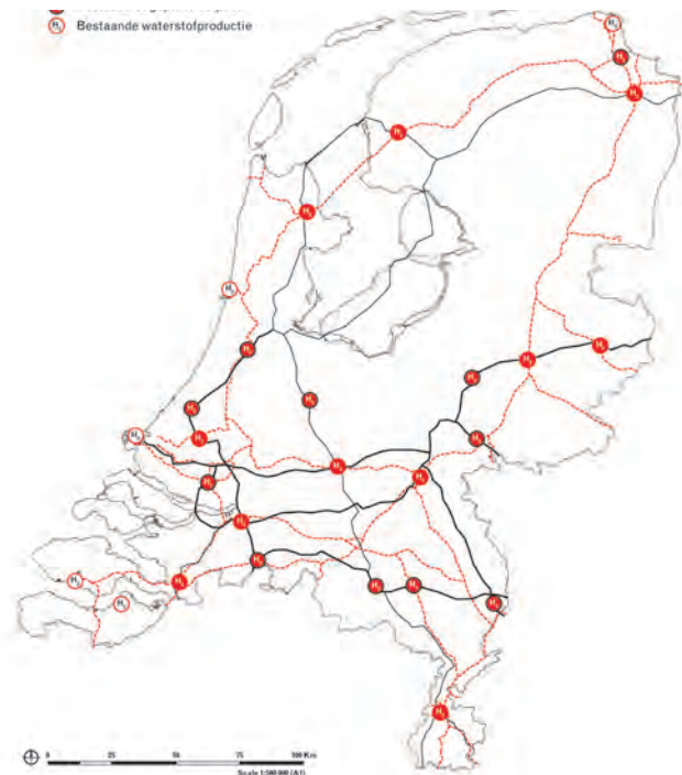
AFBEELDING 14: MOGELIJKE LOCATIES VOOR WATERSTOFVULPUNTEN (BESTAAND EN NIEUW) WAAR BUISLEIDINGEN EN CORRIDORS ELKAAR KRUISEN (L-BOVEN), SNELLAADSTATIONS VOOR VRACHTVERKEER NABIJ TRANSFORMATORSTATIONS (R-BOVEN) EN LAADSTROKEN VAN 40KM LENGTE OP EEN ONDERLINGE AFSTAND VAN 40KM, EVENEENS NABIJ TRANSFORMATORSTATIONS (R-ONDER)
